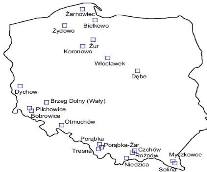
Rys. 16. Lokalizacja dużych elektrowni wodnych w Polsce
